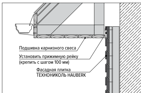
Рис. 9.1. Монтаж верхнего ряда под карнизным свесом
